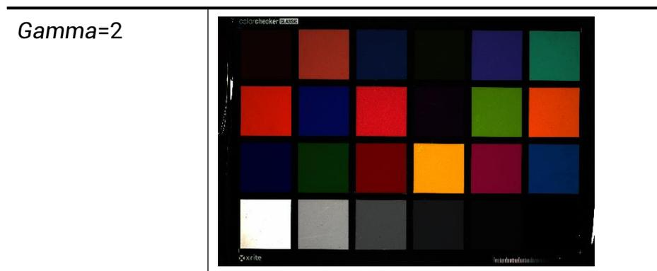
Gamma 校正分为 User 和 sRGB 两种方式。通过 *Gamma Selector* 参数进行设置。User 为用户自定义模式，可自行设置 *Gamma* 的数值；sRGB 为标准协议模式。两者的设置方式略有差别。
