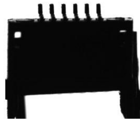
使用平行背光源，圖像均勻針腳平整度 輪廓清晰易檢測
