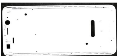
利用無影光源可清楚的拍到手機殼孔位置的檢測
