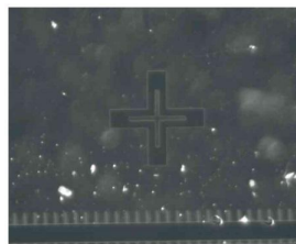
使用環形燈直接打光上去的成像，有反光 MARK不清晰
