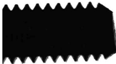
使用同軸光源打光的效果， 邊緣模糊
