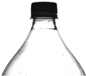
用平行背光源做輪廓量測尺寸
