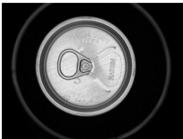
檢測易開罐拉環定位
