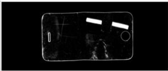
使用線光將手機蓋板打亮，上面暗點跟污垢雜質有明顯對比
