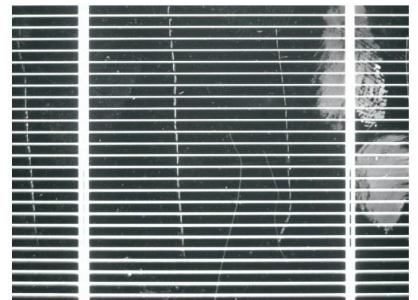
使用角形燈四面可調照射 刮傷，污點清晰可見
