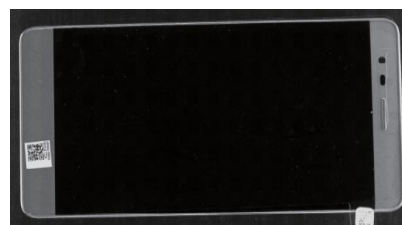
利用無影光源檢測手機二維碼，使表面的照射均勻易針對二維碼特徵對比明顯
