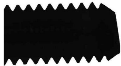
使用同軸平行光源，打光的 效果超清晰明顯易檢測
